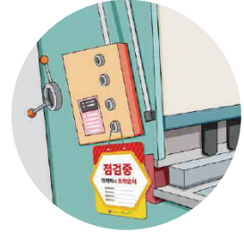
정비·보수시 전원 차단 및 임의 조작 금지 표지 부착
