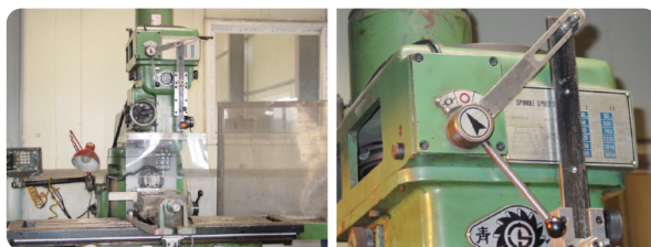
기동레버와 수동조작용 샤프트(Shaft)가 링크되어 연동된 모습
