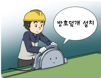
노출된 절단부 덮개 설치
