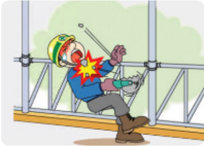
콘크리트 날아와 맞음
