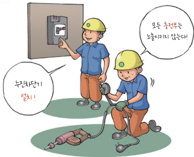
누전차단기 설치 및 절연조치
