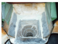
원료투입구 내부 그물망 설치
