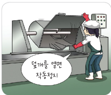
덮개 및 연동장치 설치
