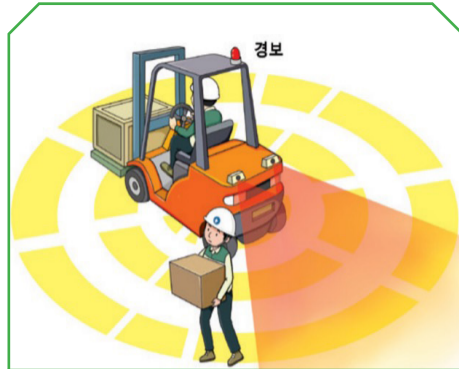
차량계 건설 및 하역운반기계 스마트 안전장치 (충돌방지장치)
