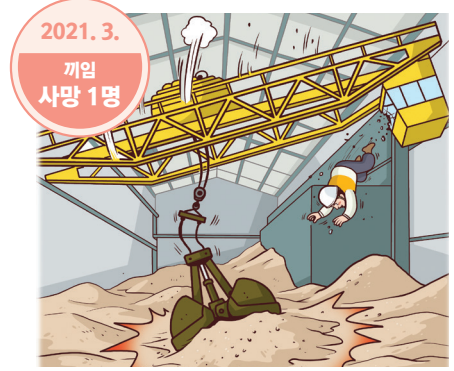
▶ 노후화된 천장크레인에 버킷 용량 이상의 인양물을 운송하던 중 크레인 거더가 파단되어 크레인和我一起 떨어짐
