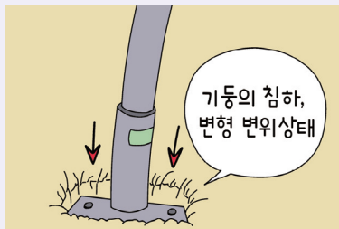
기둥 침하, 변형, 변위(變位) 또는 흔들림 상태
