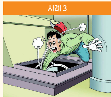
배합기 가동 도중 개방되어 있는 점검구를 통해 점검 작업 수행 중 배합기의 회전날과 점검구 사이에 끼임
