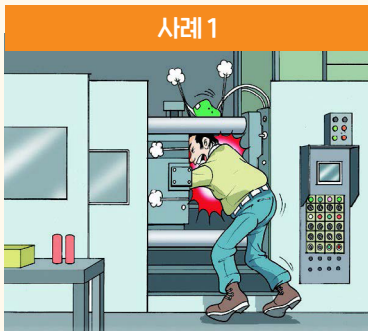
다이캐스팅 기계 내부점검, 정비 작업 중 기계가 작동되어 금형 사이에 끼임
