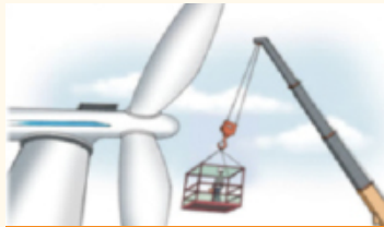
풍력발전기 설비(풍력터빈 등) 설치 해체 작업
