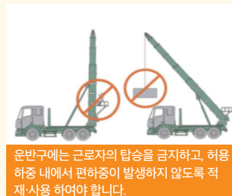
2021. 7. 떨어짐 사망 1명 이삿짐 운반구 탑승 후 운반구 이동 중 와이 어로프 파단되어 운반구 낙하하여 떨어짐
