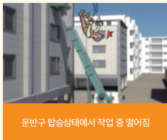
2021. 7. 떨어짐 사망 1명 이삿짐 운반구 탑승 후 운반구 이동 중 와이 어로프 파단되어 운반구 낙하하여 떨어짐
