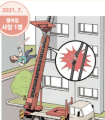
2021. 7. 떨어짐 사망 1명 이삿짐 운반구 탑승 후 운반구 이동 중 와이 어로프 파단되어 운반구 낙하하여 떨어짐
