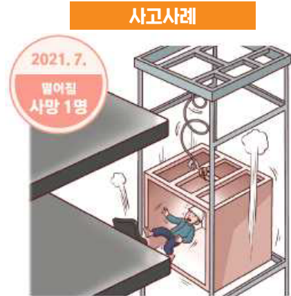
▶ 리프트 사이에 끼인 화물을 제거하고자 하강버튼을 눌러 체인이 내려가 있는 상태에서 운반구에 끼여있는 화물을 제거하자 운반구가 떨어짐
