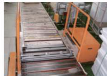
측면 방호를 설치
